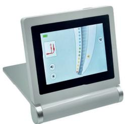
Rilevatore apicale ultraleggero solo 2,7gr, sottilissimo solo 2cm di spessore. Display touchscreen TFT-LCD a colori, dimensioni del display 73.44x48.96mm, risoluzione 480x320. Tempo di ricarica 3 ore.
