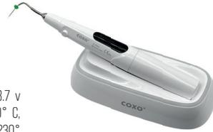
C-Fill P con batteria ricaricabile agli ioni di litio 3.7 v 2200mAh, tempo di riscaldamento 4 SEC. ai 200°C, temperatura di esercizio 150°C, 180°C, 200°C, 230°C, ingresso scheda 100-240 Vca, uscita DC5V, 1.5 A, termofofo 23G, 25G. Fornito con 5 plugger.
