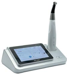
Motore endodontico reciprocante a led e rilevatore apicale. Schermo full touch a colori. Wireless, collegamento bluetooth. Torque 0,6/3,9 Ncm, velocità di rotazione 150-1000rpm.
