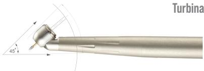
Testina chirurgica standard 45°, corpo in titanio, 320.000-400.000 giri/min. Dimensioni della testina Ø11,2 x H14 mm, rumorosità inferiore a 65 dB, 4 fori spray con fibra ottica. Cuscinetti ceramici, regolazione della pressione dell'aria.
