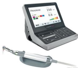
Motore endodontico reciprocante con rilevatore apicale incluso. Ampio schermo LCD a colori, comando a pulsante di facile utilizzo, sistema di illuminazione a LED separabile per una migliore visibilità operativa. Micromotore compatibile con testina ENDO MATE NSK® 16:1. Torque 0,6/4,0Ncm, velocità di rotazione 100-650 giri/min.
