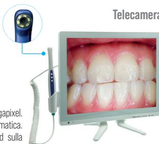
Monitor con telecamera. Risoluzione 5 megapixel. Distanza focale 3-50mm, messa a fuoco automatica. Sensore d'immagine 1/4 Sony HAD CCD, 6 led sulla testina del manipolo per una migliore visibilità. Diverse funzioni. Segnale NTSC/PAL. Porta HDMI e USB
