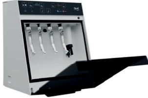
Lubrificatrice, durata del ciclo 20 secondi per una turbina, 40 secondi per un contrangolo. Capacità 4 vie (2 pulizia, 2 lubrificazione) e una linea per il mandrino. Pressione d'aria 0,3Mpa fino a 0,5Mpa (raccomandata 0,4 Mpa). Peso 8kg ca. Dimensioni esterne larghezza 300mm, profondità 300mm, altezza 365mm. Garanzia 24 mesi.
